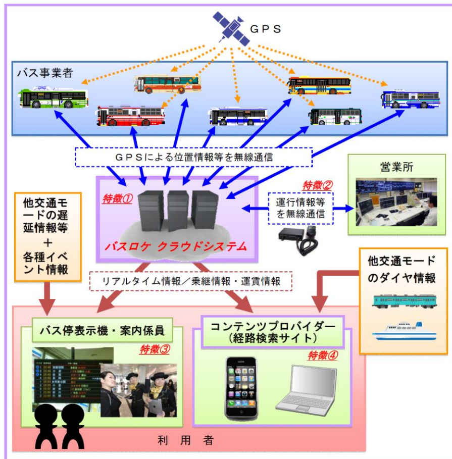
図 4-1 バスロケーションシステムの基本構成（イメージ図） 資料）広島県バス協会
